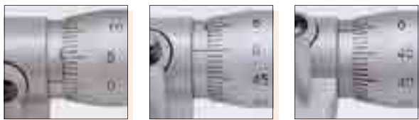
(a) Ligne de foi vue du dessus (b) Vue directe de la ligne de foi (c) Ligne de foi vue du dessous
