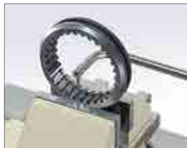
> Denture intérieure d'engrenage.
