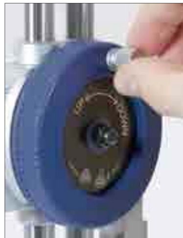
> Pignon actionné par une manivelle.
