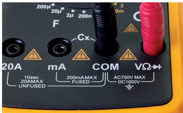
Figure 1-20. Autre exemple de connecteurs d'un multimètre.
