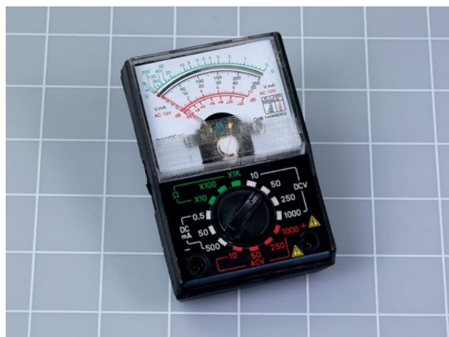
Figure 1-1. Ce type de multimètre à aiguille ne convient pas à votre besoin. Vous devez choisir un multimètre numérique.
