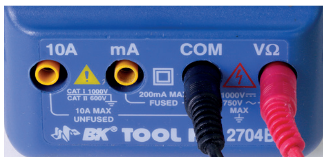
Figure 1-18. Remarquez le marquage des connecteurs de ce multimètre.
