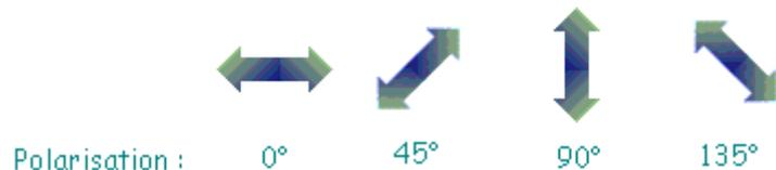
Il nous faut pouvoir détecter la polarisation des photons. Pour cela, on utilise un filtre polarisant suivi d'un détecteur de photons. Si un photon polarisé à  $0^\circ$  rencontre un filtre polarisant orienté à  $0^\circ$ , il traverse ce filtre polarisant et est enregistré par le détecteur placé juste après. Si un photon polarisé à  $90^\circ$  rencontre le même filtre, il est immédiatement stoppé, et le détecteur n'enregistre rien.
