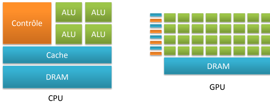
FIGURE 4.8 – Comparaison simplifiée des architectures de type CPU face aux architectures de type GPU : les différences principales résident dans le nombre d'unités de calcul de chaque type de matériel ainsi que dans leurs fréquences d'horloge respectives. D'un côté les CPU possèdent quelques unités de calculs (des « cœurs ») bien adaptés à du parallélisme de tâches et gérant bien du code « complexe » contenant des branchements conditionnels. En outre ces unités de calcul ont une fréquence d'horloge élevée (plusieurs giga hertz). De l'autre, les GPU sont constitués de milliers d'unités de calcul très simples et adaptées à du parallélisme de données. Les branchements dans le code sont à éviter sur ce type d'architecture. Les fréquences des processeurs graphiques montent rarement au delà de un giga hertz. Concernant la mémoire, les deux architectures possèdent une mémoire hiérarchisée, constituée de registres, de caches et d'une mémoire principale. Les caches sont toutefois plus importants sur les CPU.
