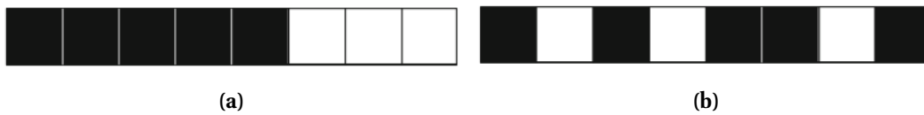
FIGURE 5.13 – Fragmentation mémoire lors d'une simulation. Les cases noires représentent des entités vivantes, les cases blanches des entités mortes. (a) En début de simulation, les entités vivantes sont stockées de manière contiguës en mémoire. (b) Au fur et à mesure que les pas de simulation s'enchaînent, des entités meurent ou se répliquent et les cases vides et non vides se « mélangent » dans la mémoire : on parle alors de fragmentation.
